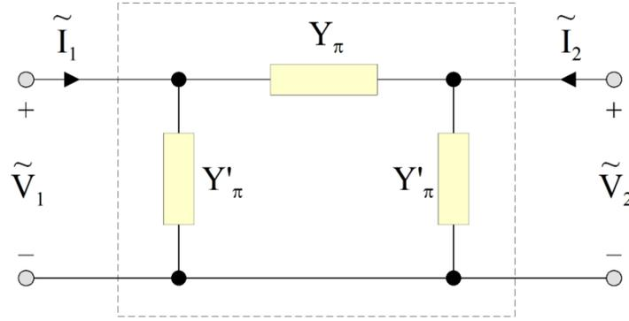
**Figure 3.21:  $\pi$  -equivalent Circuit**
